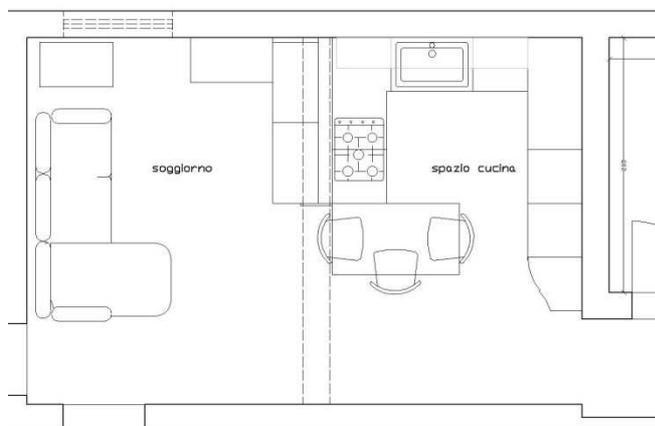
Abbattendo il tramezzo del cucinotto, si ottiene uno spazio aperto di notevoli dimensioni. A separare la zona della cucina, un muretto realizzato in cartongesso, di cm. 120 di altezza e 15 cm. di profondità
